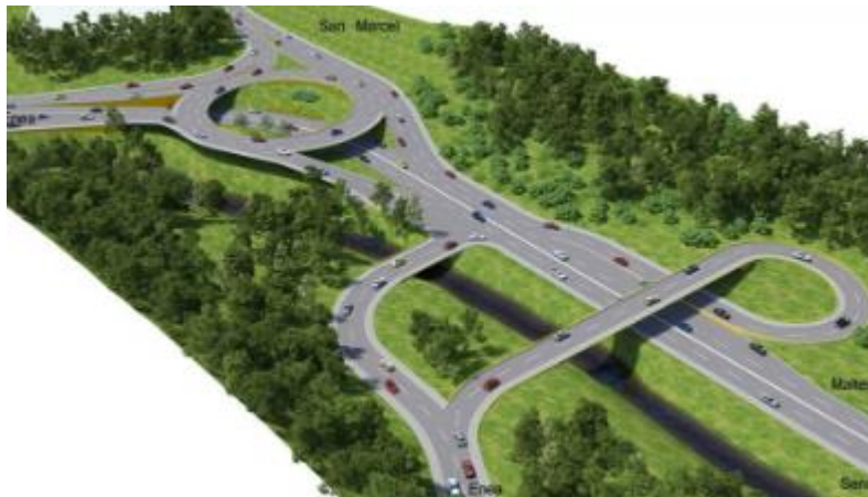
Imagen 3: Esquema geométrico en 3D de la Intersección San Marcel. Fuente: INVIAS.
