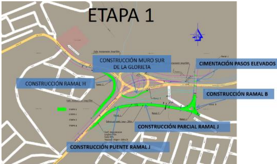
Imagen 2: Obras a construirse durante la Etapa I de la construcción de la Intersección San Marcel. Fuente: Dirección Territorial Caldas – INVIAS.
